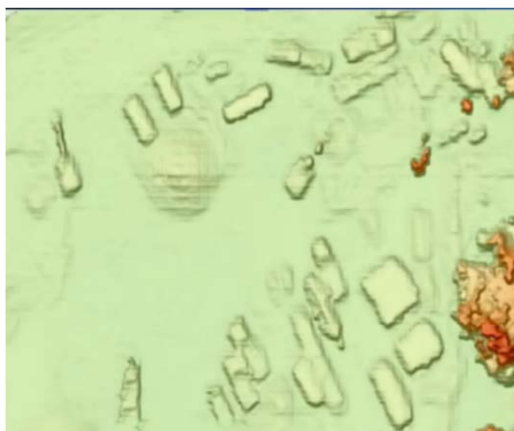
Рисунок 1 - цифровая модель, созданная на основе данных с LIDAR
